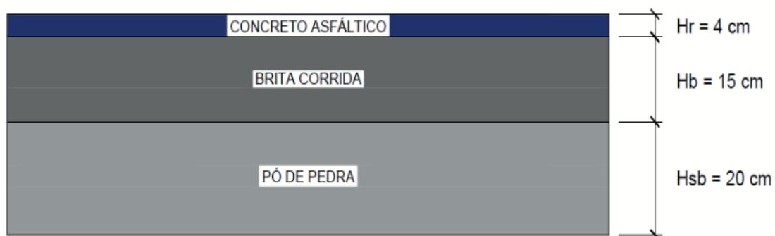
Figura 2 – Estrutura do pavimento estimado
