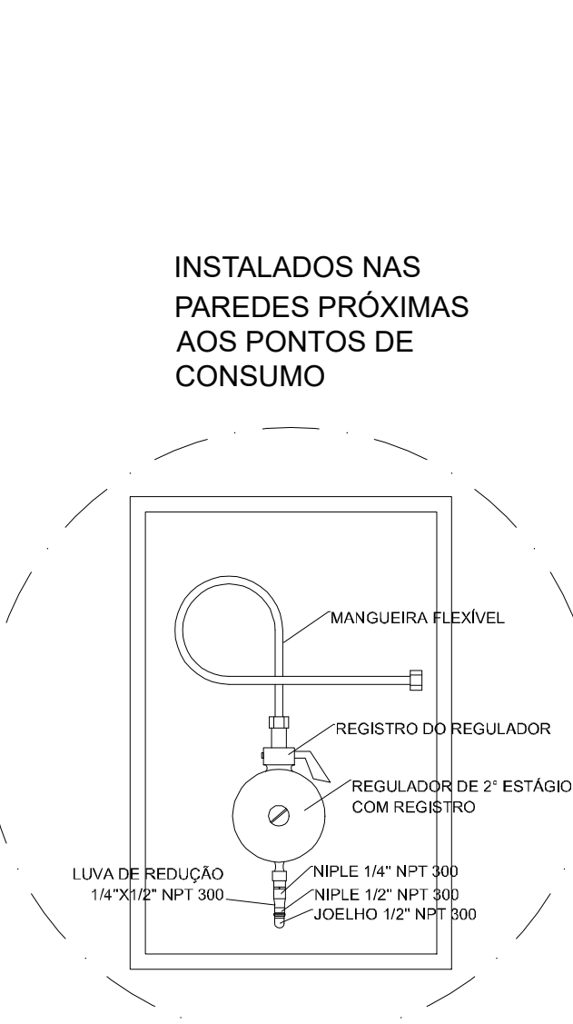
6 DETALHE "B" REGULADOR DE 2º ESTÁGIO SEM ESCALA
