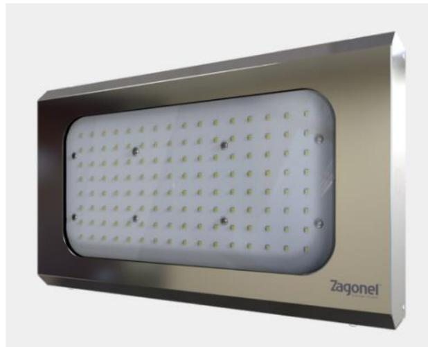
Características Técnicas: Refletor de led, potência nominal 100W, com policarbonato leitoso, temperatura de cor 6500k, fluxo luminoso 15.000lm. equipado com ganchos para instalação em perfilado, modelo zl-3422, fabricante Zagonel.
