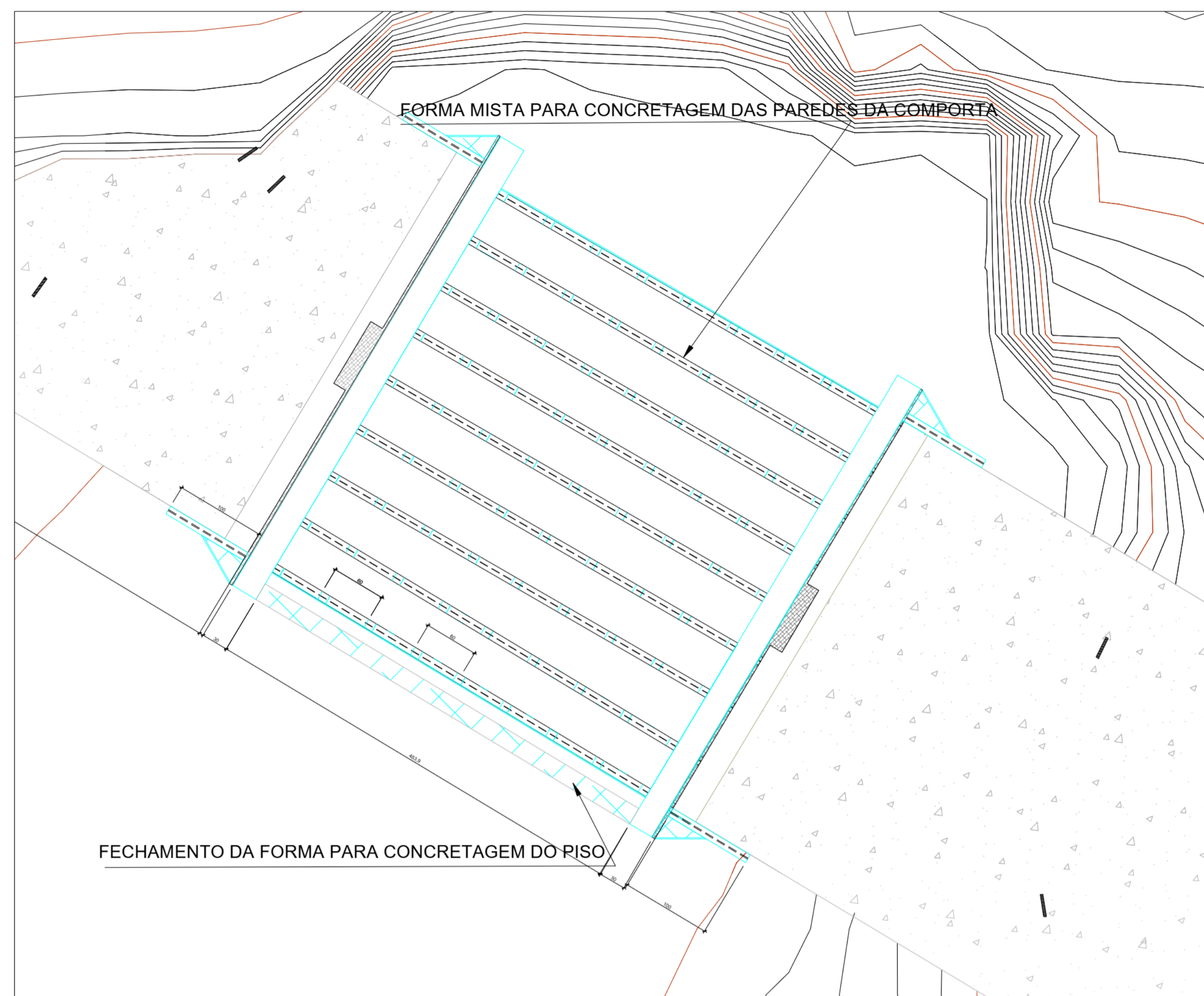
FORMAS E ESCORAMENTO PARA EXECUÇÃO DAS PAREDES E PISO DA COMPORTA ESC. 1:25 Vista Superior
