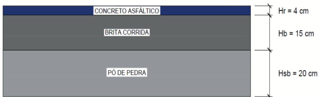
Figura 2 – Estrutura do pavimento estimado
