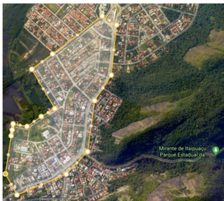
Figura 2 – Delimitação da bacia de contribuição da Estrada da Serrinha. (Fonte: Google Earth)
