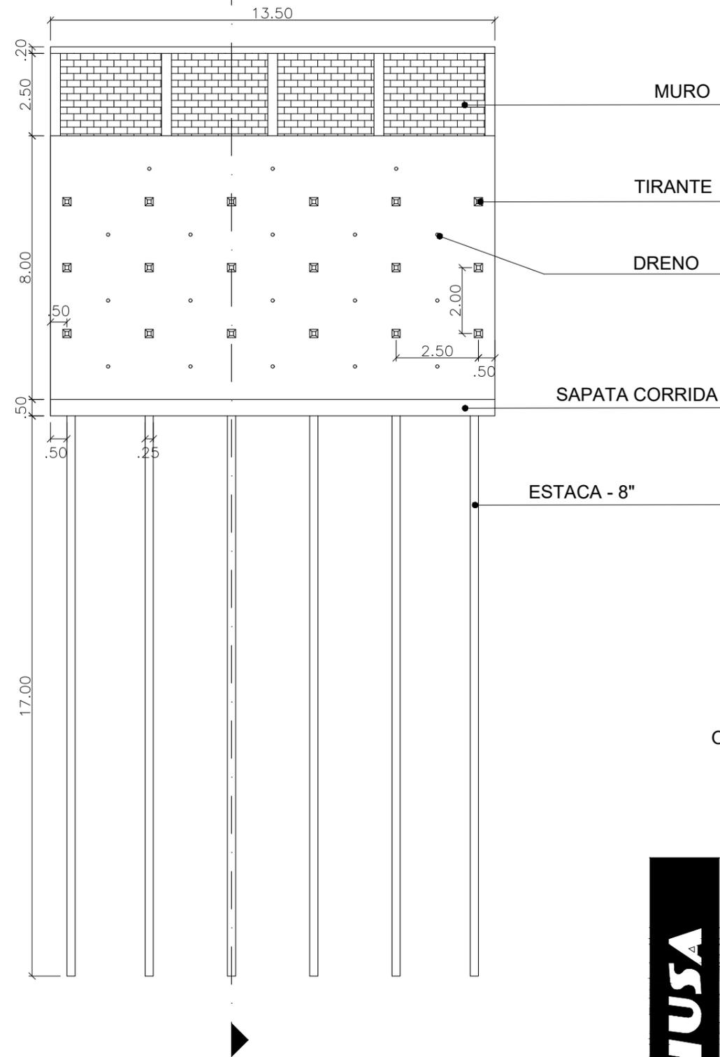
OBS: OS DRENOS DA LINHA SUPERIOR POSSUEM 75mm DE DIÂMETRO, OS DEMAIS POSSUEM 100mm DE DIÂMETRO, TODOS COM 60 cm DE COMPRIMENTO.
