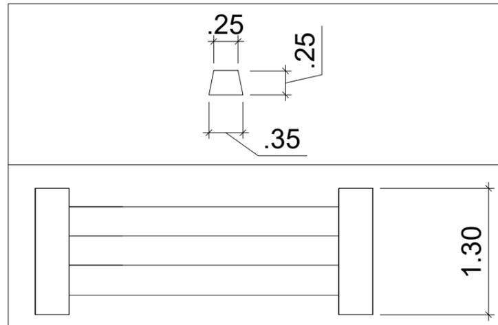
SEÇÃO TRANSVERSAL GUARDA CORPO - 0,07M<sup>2</sup>
