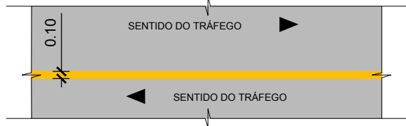
DETALHE 10 - LINHA DE DIVISÃO DE FLUXOS OPOSTOS - LINHA SIMPLES CONTÍNUA (LFO-1) TINTA: TERMOPLÁSTICA (EXTRUSÃO) COR: AMARELA ESC: 1/75
