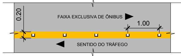
DETALHE 11 - MARCAÇÃO DE FAIXA EXCLUSIVA DE ÔNIBUS (MFE) TINTA: TERMOPLÁSTICA (EXTRUSÃO) COR: BRANCA ESC: 1/75
